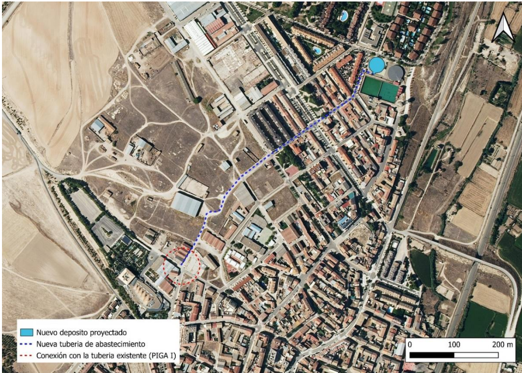
Figura 6. Trazado de la nueva tubería de abastecimiento desde el nuevo depósito hasta la arqueta de conexión con la tubería del PIGA.
